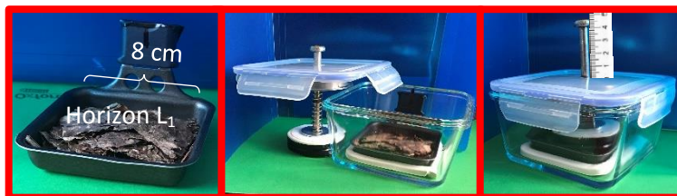
Figure 1. Biomètre mécanique de mesure de l'épaisseur des couches de feuilles L_1 et L_t
