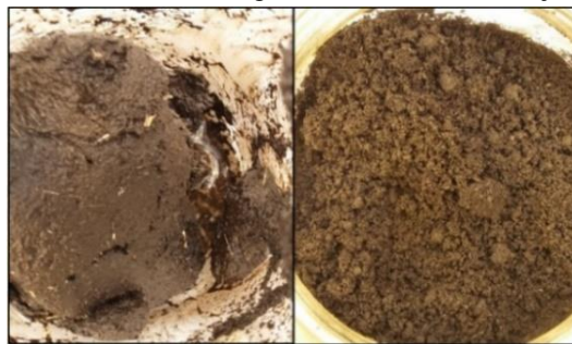
Figure 1. Affaissement du sol amendé en sorgho (gauche) par rapport au témoin (droite).
